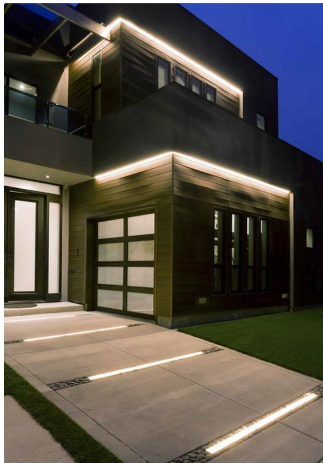
Luminaria lineal empotrada en el suelo, transitable, para ambientes externos. Las dimensiones compactas y el acabado "todo cristal" a ras permiten instalaciones en fila continua de gran elegancia y limpieza estética. El cuerpo está sometido a tratamiento de cataforesis, lo que permite su instalación en proximidad del mar (hasta 5 metros) o en ambientes "hostiles".
