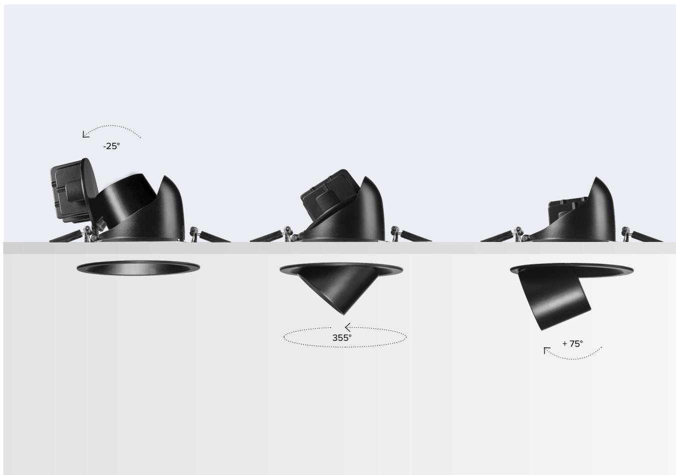
Es posible orientar de modo continuo el cuerpo óptico de  $-25^\circ$  a  $75^\circ$  en el plano vertical y de  $355^\circ$  en el horizontal. Incluso es posible desplazar el cuerpo óptico hacia el interior del falso techo para ocultar completamente la emisión luminosa.
